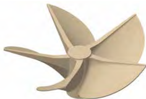
Elica di superficie per scafi plananti. ( surface piercing propeller for planing vessels )
