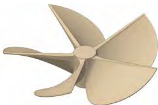
Elica di superficie per scafi plananti. ( surface piercing propeller for light planing vessels )
