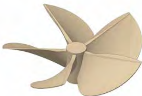
Elica di superficie con retromarcia per scafi plananti ( surface piercing propeller with backgear for planing vessels )
